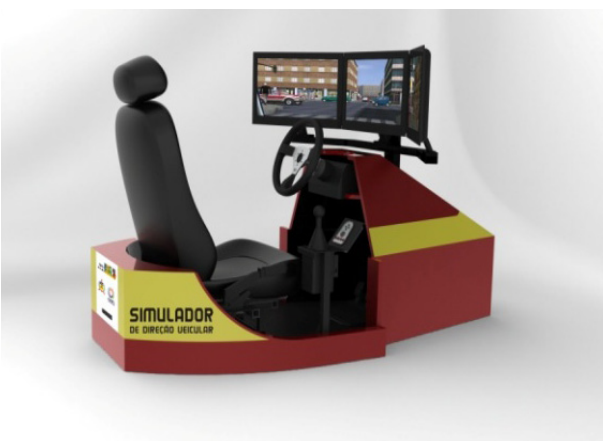
Modelo P2 – Simulador Compacto Intermediário - cockpit com 3 monitores 22”, mix de componentes automotivos e de jogos adaptados para melhor ergonomia, custo médio.
