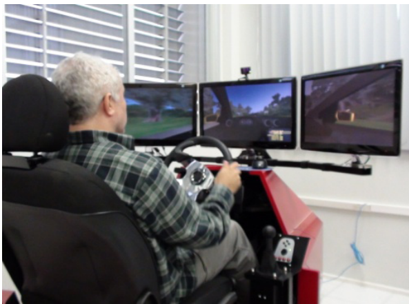
Modelo P2 – Simulador Compacto Intermediário - cockpit com 3 monitores 22”, mix de componentes automotivos e de jogos adaptados para melhor ergonomia, custo médio.
