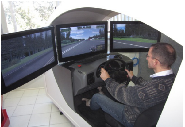
Modelo P3 – Simulador Compacto Avançado - 3 TVs 32”, cabine automotiva completa, assento com plataforma móvel, software avançado, custo mais alto.
